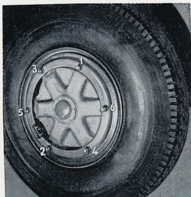
Fig. 87 - Ordre de serrage des roues avant.
