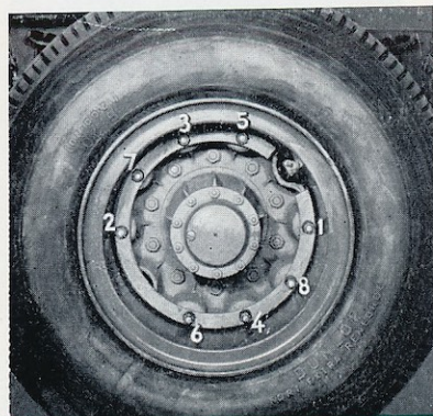
Fig. 88 - Ordre de serrage des roues arrière.
