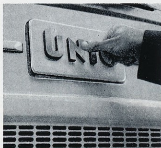
Fig. 19 - Ouverture du volet d'accès au remplissage du radiateur (cabine avancée)
