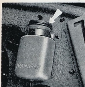
Fig. 16 - Emplacement du réservoir du lave-glace (cabine semi-avancée)
