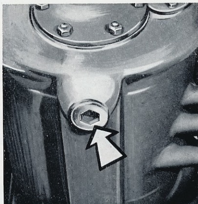
Fig. 61 - Vidange de la boîte de vitesses B 178 RS.
