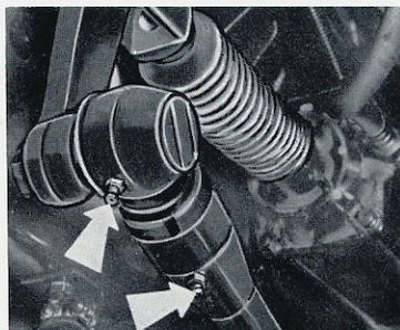
Fig. 76 - Graissage de la barre de direction et rotule (cabine avancée).
